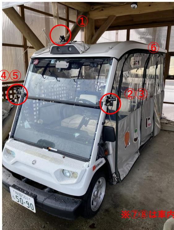
車載カメラを合計8か所に設置
