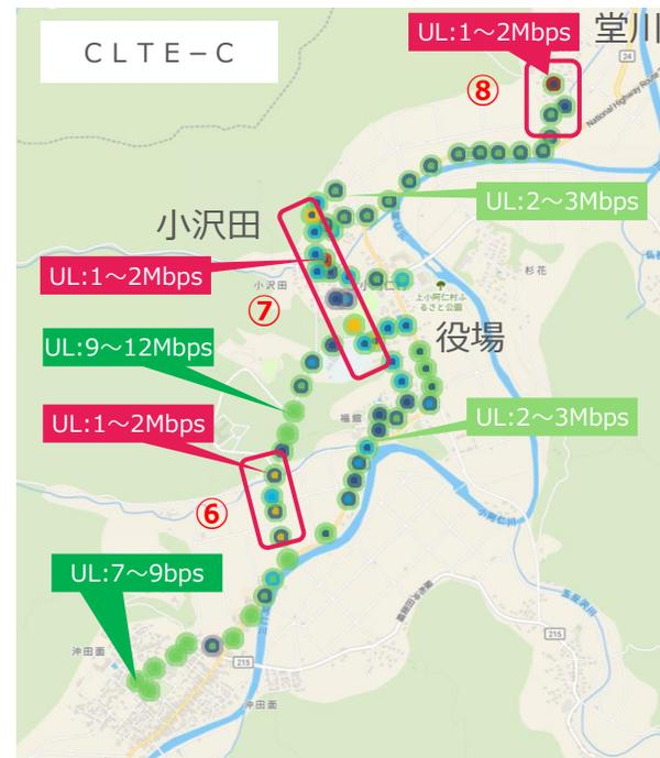
**赤線エリア**が、各キャリア毎に不感（電波強度や品質が良くない）に近い場所となります。通信帯域確保のためには、最低2キャリアとプラスアルファの電波強度と品質が必要と考えられます。
