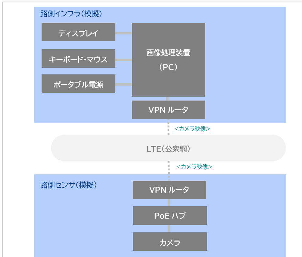
図 5-24 路側インフラ模擬環境システム構成
