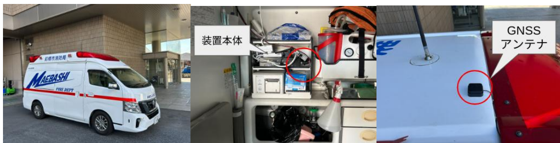
図 6-41 緊急車両への設置写真
