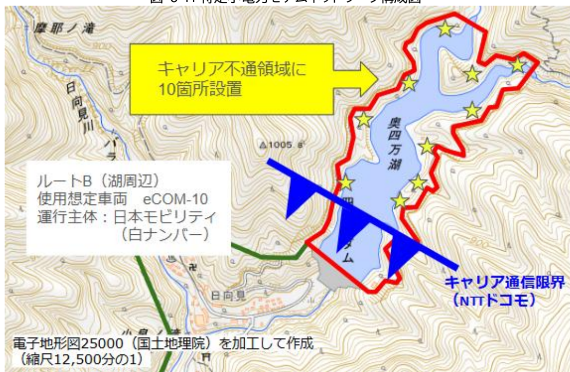
図 5-11 特定小電力モデムネットワーク構成図
