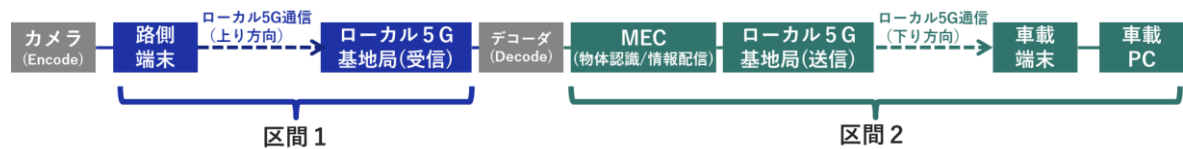
図 4-9 路側カメラから自動運転システムまでの情報伝達経路
