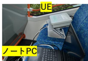
図 5-3 自動運転バス車内の機器写真
