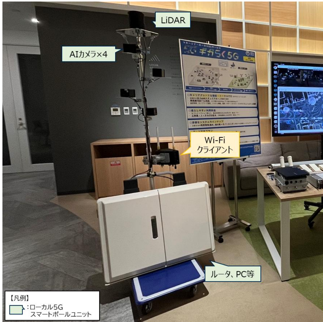
図 5-15 ローカル 5G スマートポール（可搬型）の写真
