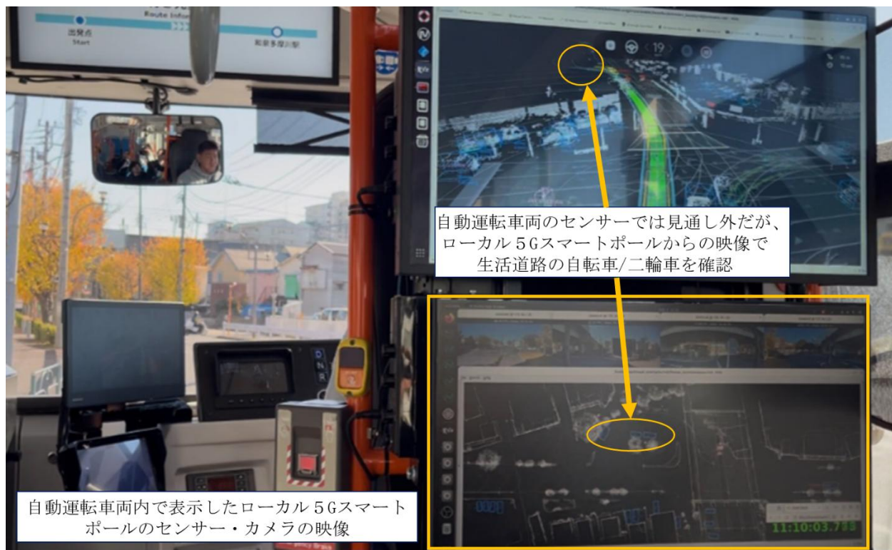
図 6-22 自動運転車両内のローカル 5G スマートポール映像確認模様
