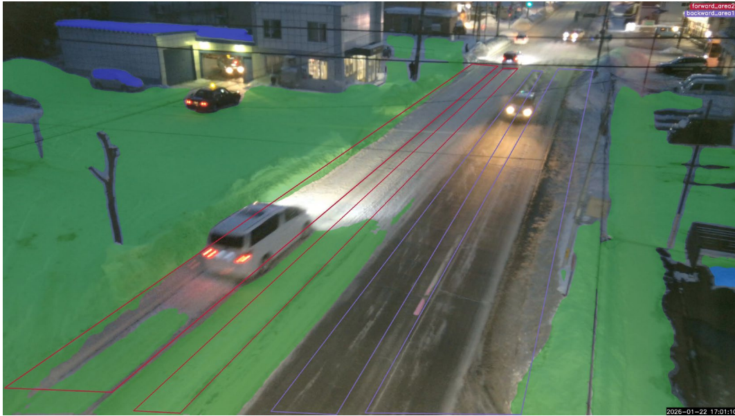
図 28 画像による積雪判定結果が不良のシーン(2026 年 1 月 22 日・道路灯 1) 赤色矩形:往路各車線の走行判定エリア、紫色矩形:復路各車線の走行判定エリア
