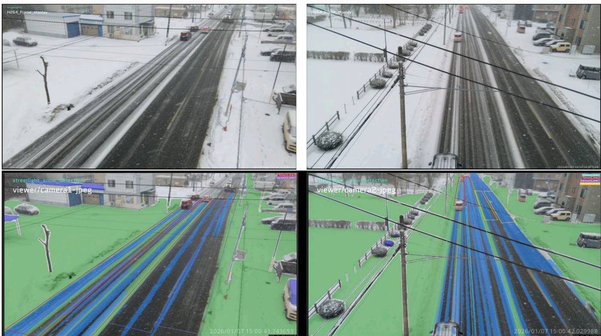
図 25 元画像と積雪検知結果の比較 (水色:路面が見える程度の薄い雪、緑色:路面が見えない程度の雪、紫色:路面以外の雪)
