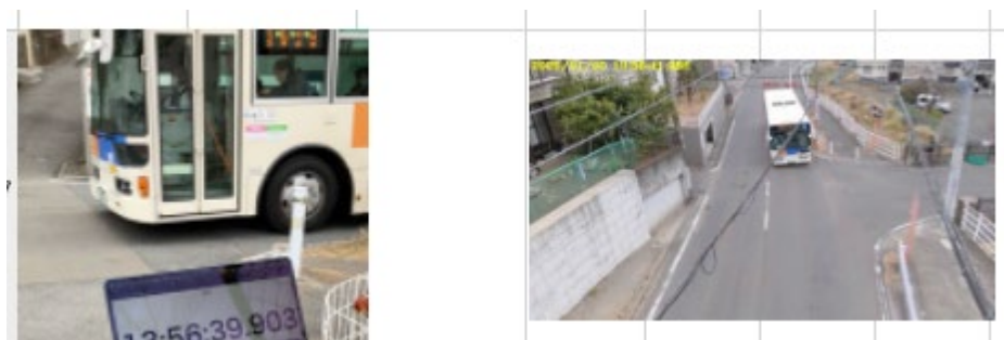
図 91 離合制御における遅延計測イメージ(左が現地の時間、右が AI で検知した時刻)
