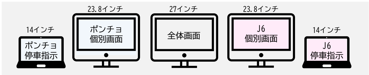
図 16 自動運転バス 2 台監視の際のモニタの配置
