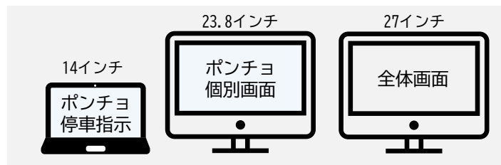
図 15 自動運転バス 1 台監視の際のモニタの配置
