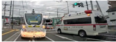
図 42 救急車を検知して停止、ハザード点灯する様子
