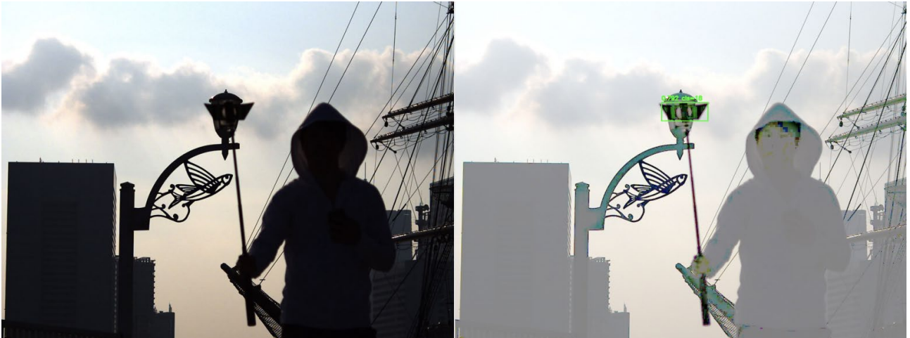
図 6-6-1-41:逆光復元アルゴリズムの復元結果(左が元の画像、右が逆光復元した画像)
