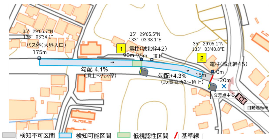
図 4-4-1-6:路側センサー設置位置—右折する交差点の先の坂修正 (出典:国土地理院地図)
