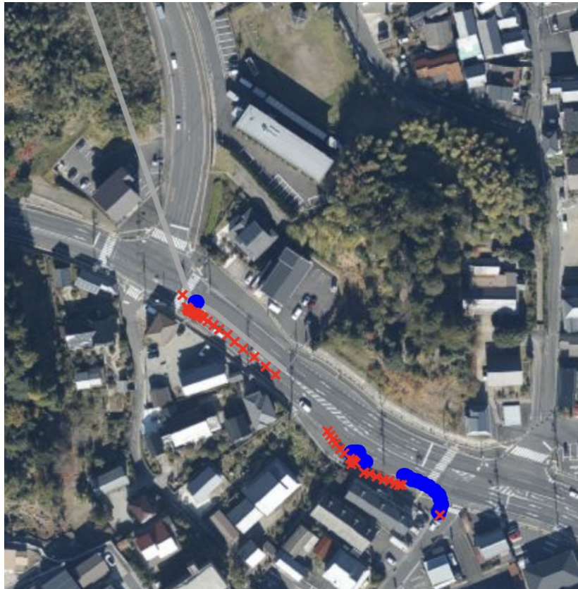
図 6-6-1-13(1):ルート2における通信失敗例(11月11日16時00分～16時05分区间) パケット通信結果の例を図示 青丸:OK 赤×:NG (出典:国土地理院地図)
