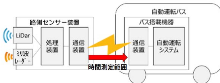
図 6-4-1-9:時間測定方法の概要図
