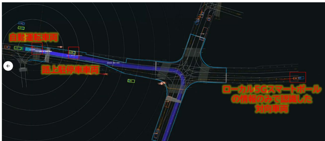
図 6-28 インフラ協調により遠方の対向車両を早期に認識したシーン②
