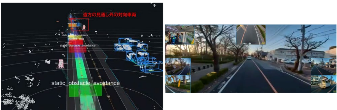
図 4-50 ローカル 5G スマートポール情報の表示 (左:自動運転システム、右;遠隔監視映像)
