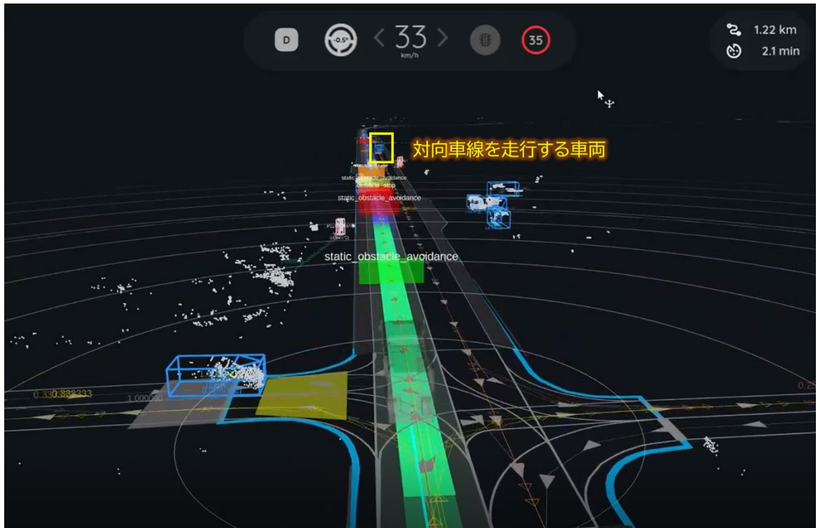
図 6-22 自動運転車両が対向車線の車両を認識する様子
