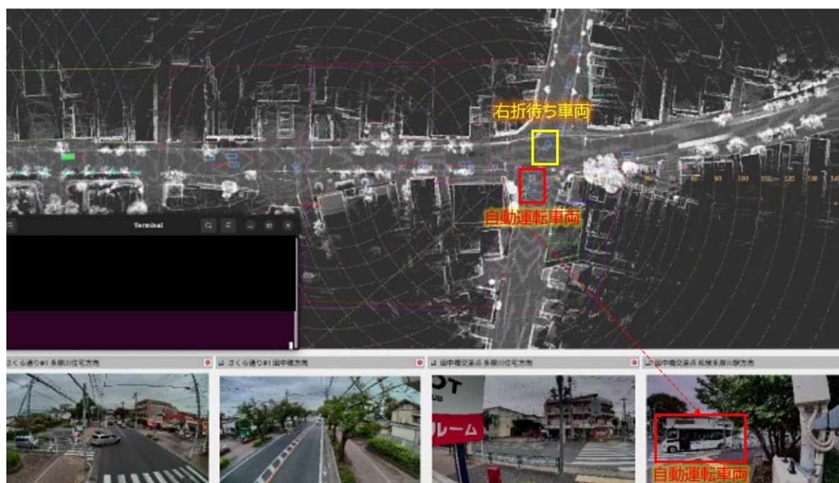
図 6-18 ローカル 5G スマートポールにて物標情報を認識する様子
