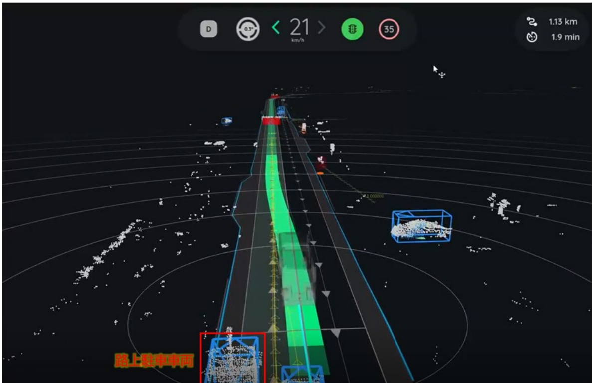
図 6-25 路上駐停車車両を回避して自車線に復帰している様子
