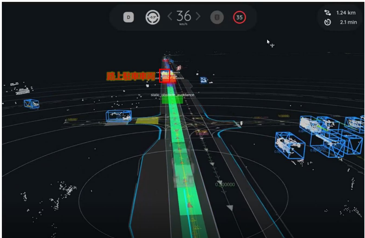
図 6-21 自動運転車両で路上駐車車両を認識する様子
