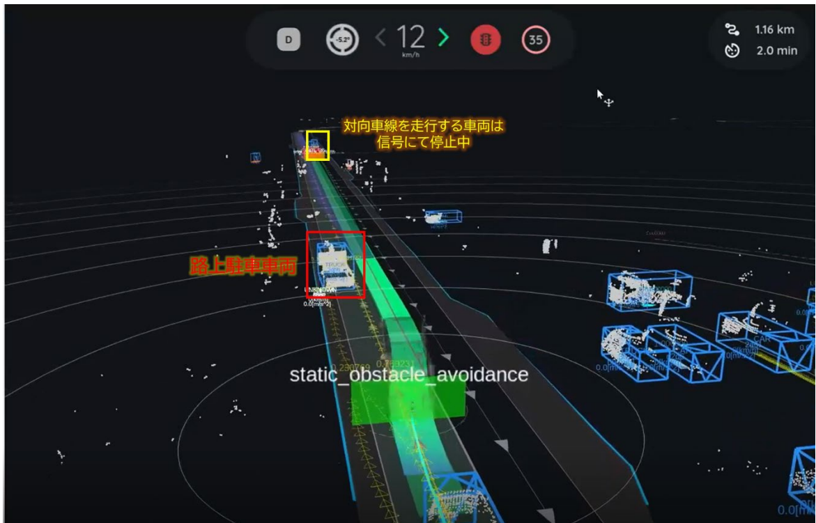
図 6-24 路上駐停車車両を回避する様子
