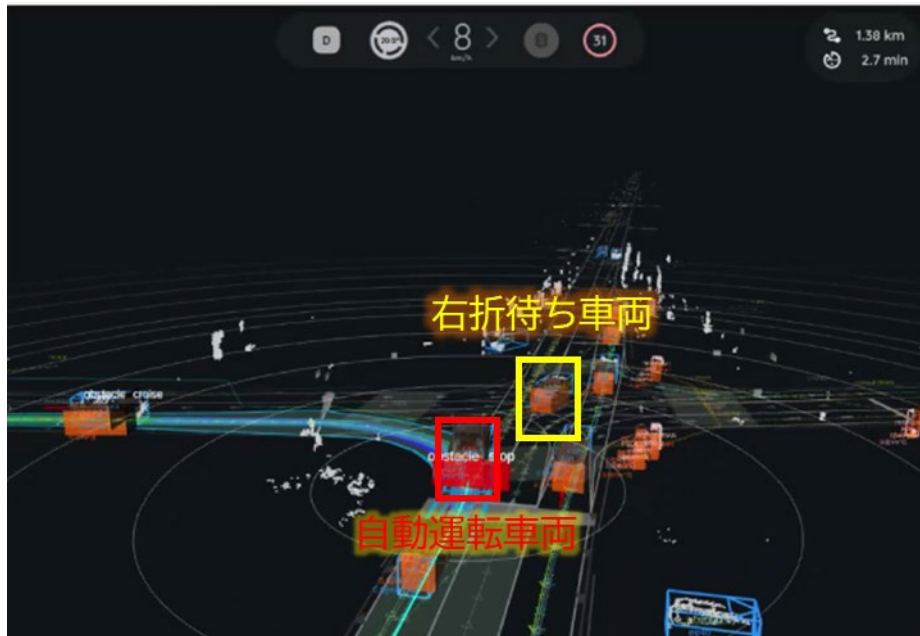
図 6-19 ローカル 5G スマートポールの情報が自動運転車両の画面に表示される様子
