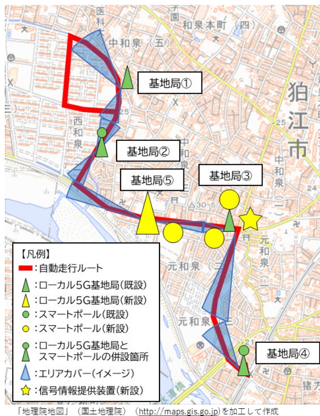
図 4-4 ローカル 5G スマートポール設置箇所
