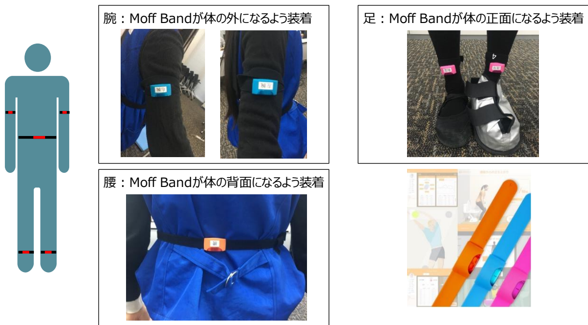
図表 8 加速度センサーの取付方法
