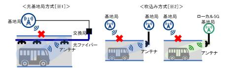
[※1]トンネル近傍に基地局関連設備を配置し、トンネル内には光ファイバーで接続したアンテナを設置することで、トンネル内で電波を放出する方式 [※2]トンネル出入口付近に指向性が高いアンテナを設置し、トンネルに向けて直接電波を放出する方式
